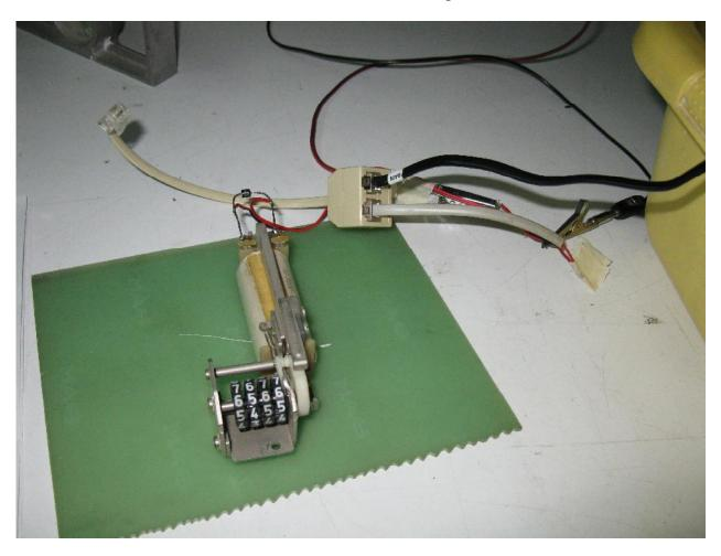
Il flusso dell'acqua in caduta è stato mantenuto con una frequenza di scatto della bascula ogni 6÷8 secondi che significa un rain rate di circa 80÷100 mm/ora.
